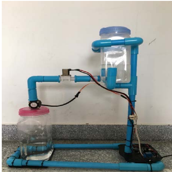
ภาพที่ 5 แบบจำลองระบบควบคุมและตรวจสอบการใช้น้ำประปา
