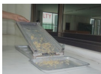
(ข) การทดสอบมุมการไหลข้าวเปลือก
