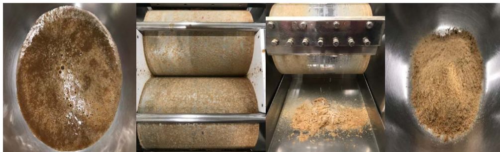
ภาพที่ 2 ขั้นตอนการทำน้ำพริกผงเรือดาร์บวังสวนสุนันทากึ่งสำเร็จรูปเมื่อผลิตด้วยวิธีการทำแห้งด้วยเครื่องทำแห้งแบบลูกกลิ้ง
