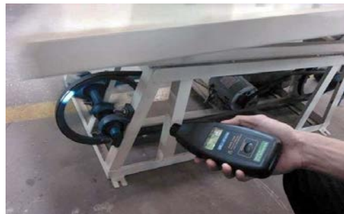
ภาพที่ 5 การวัดระดับความเร็วรอบตะแกรงโยก
