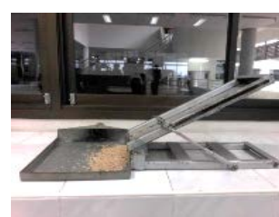
(ข) การทดสอบมุมการไหลข้าวเปลือก
