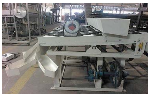
ภาพที่ 4 การปรับตั้งระยะมุมเอียงตะแกรงโยก
