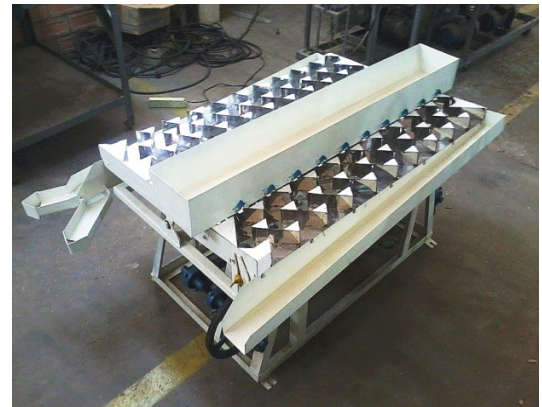
ภาพที่ 8 เครื่องคัดแยกข้าวเปลือกออกจากข้าวกล้องแบบตะแกรงโยก
