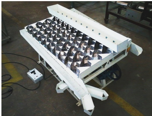
ภาพที่ 8 เครื่องคัดแยกข้าวเปลือกออกจากข้าวกล้องแบบตะแกรงโยก
