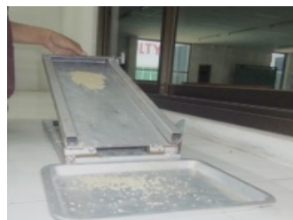
(ก) การทดสอบมุมการไหลข้าวกล้องเต็มเมล็ด
