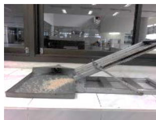
(ก) การทดสอบมุมการไหลข้าวกล้องเต็มเมล็ด
