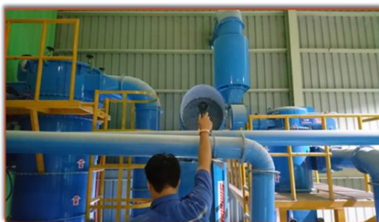
ภาพที่ 1 จุดที่ทำการวัดความเร็วลมจากปลายปล่องลมทิ้งของเครื่องดูดฝุ่นชนิดตุ้งกรอง ขนาด 50 แรงม้า
