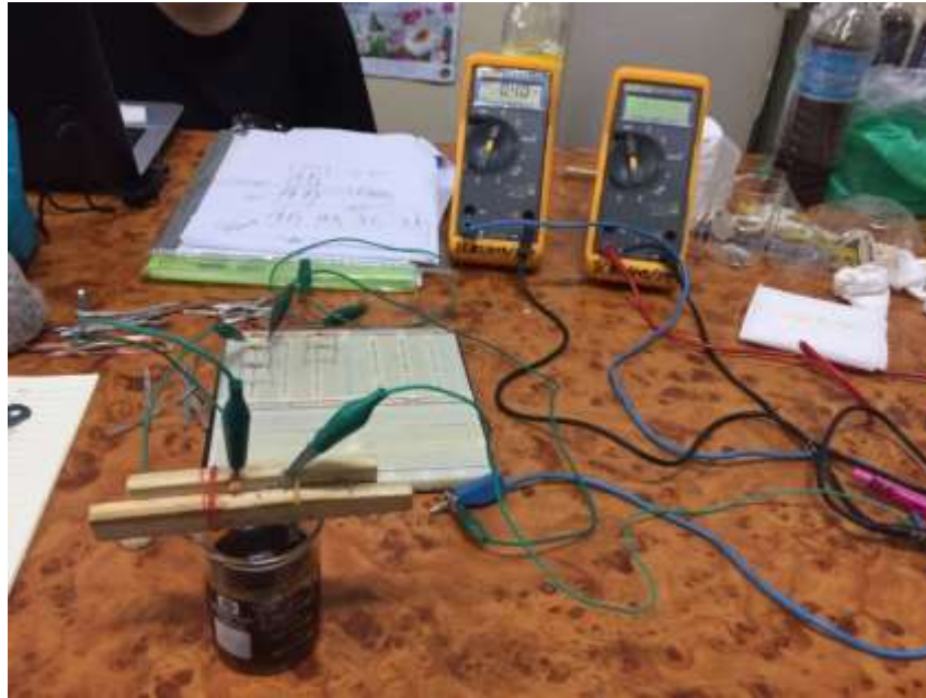
รูปที่ 7 การวัดค่าศักย์ไฟฟ้า และค่ากระแสไฟฟ้าด้วยดิจิตอลมัลติมิเตอร์ ที่มา : ภาพถ่ายโดย น.ส.ศิริพร ค่ายอง เมื่อวันที่ 10 มีนาคม พ.ศ. 2560
