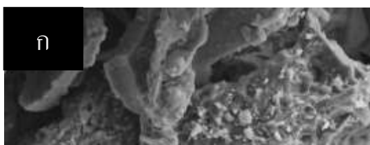
ภาพที่ 2 แสดงลักษณะทางกายภาพที่กำลังขยาย 5000 เท่าของเปลือกกล้วยน้ำหว่าที่เตรียมถ่านกัมมันต์โดยวิธีคาร์บอนเซชันและวิธีกระตุ้นทางเคมี เผาอุณหภูมิที่ 700°C เป็นเวลา 2 วิธีคาร์บอนเซชัน สเกลบาร์ (ก) ชั่วโมง โดย 2 ไมโครเมตร 1 วิธีกระตุ้นทางเคมี สเกลบาร์ (ข) ไมโครเมตร
