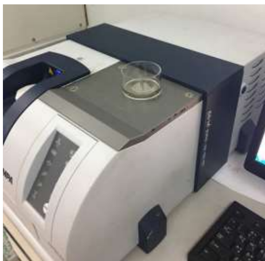
ภาพที่ 1 การบันทึกสเปกตรัมเนียร์อินฟราเรดด้วยเครื่อง FT-NIR spectrometer
